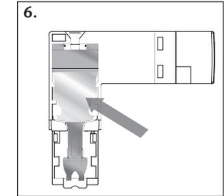
**DE** Die Drähte entsprechend der Farbcodierung des RJ45-Steckers anordnen.
